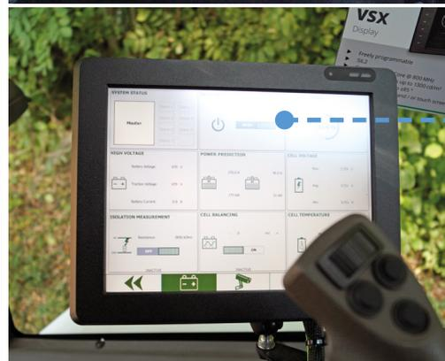
In der Kabine findet sich das Display VSX, über das sich beispielsweise der Ladezustand der Batterie ablesen lässt, sowie die Bordsteuerung mBCX-PB und das Konnektivitätsmodul TC3G, das die Fahrzeugdaten in die Cloud sendet.
