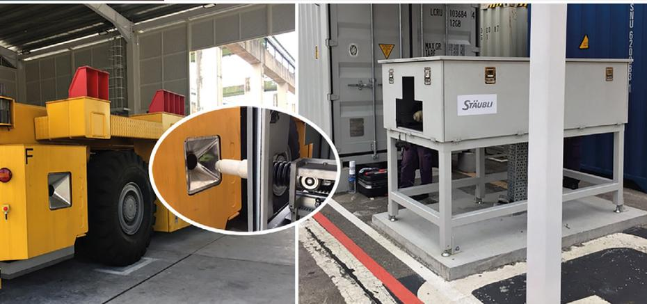
Um die FTS konstant im Fluss zu halten und die Arbeitsabläufe nicht zu unterbrechen, kommen automatische Batteriewechselsysteme oder hochleistungsfähige Ladestationen zum Einsatz. Wichtig dabei: der Ladevorgang muss schnell abgewickelt werden, um Stillstandszeiten zu vermeiden und die Kosten tief zu halten. Das Schweizer Unternehmen Stäubli Electrical Connectors hat in puncto Ladeanwendungen Lösungen für nahezu jede Aufgabenstellung.
