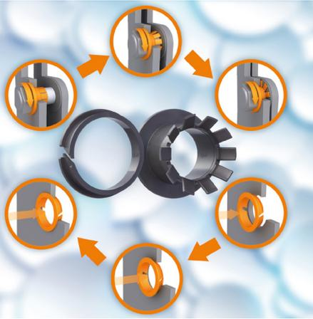
Für sichere, schmierfreie Lagerungen bietet Iglus Clips- und Umbördellager an. Diese werden vor allem in Blechdurchführungen eingesetzt. Bei der Montage wird das geschlitzte Gleitlager einfach mit dem kleineren der beiden Bünde durch die Bohrung geführt und dann eingeclipst. Eine
