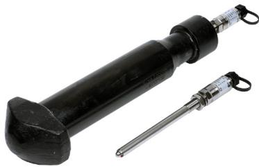
Um Container zum Verladen auf ein Schiff zeitsparend zu wiegen, bietet Tecsis die Twistlock-Sensoren Typ F9205 an. Mit ihnen können die Container beim Anheben direkt verwogen werden. Die Technik kann schon fertig montiert, kalibriert und in einen Twistlock eingebaut geliefert werden.
