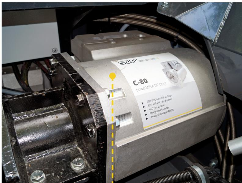
Angetrieben wird SymonE von zwei 80-kW-E-Antrieben vom Typ powerMELA. Einer treibt die Arbeitshydraulik an, der andere dient als Fahrtrieb.
