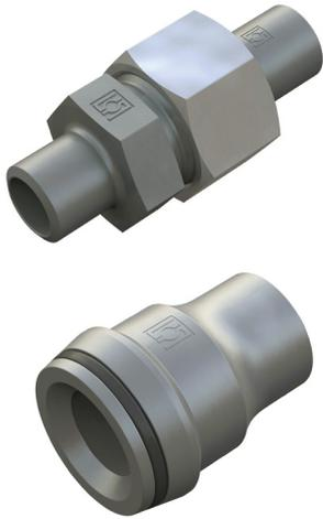
Mit den Baureihen FI-SNR und FI-ASV erweitert Stauff sein Angebot an Connect-Schweißverschraubungen. Diese Verbindungen werden zwar zunehmend durch montagefreundlichere Umformsysteme, z. B. Stauff-Form, ersetzt. Sie werden aber auch in Zukunft in der anspruchsvollen Schwerindustrie und der Kraftwerkstechnik zu finden sein. Bei der FI-SNR handelt es sich um 24°-Schweißkegelreduzierungen mit O-Ring. Hier kann der Anwender eine Rohrleitung per Schweißen mit einem Standard-
