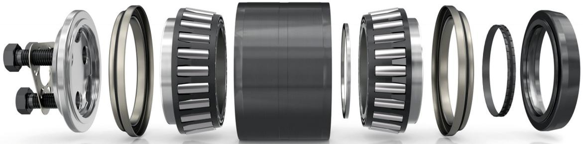
**01** Die optimierte Version des FAG-Kegelrollenlagereinheiten Tarol verfügt über eine besonders kompakte und bauraumsparende Kassettendichtung. Diese verbessert den Schutz vor Kontamination des Lagers
