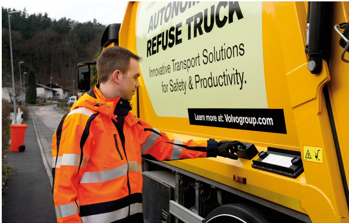
Auf Tastendruck setzt das Entsorgungsfahrzeug von selbst bis zur nächsten Abfalltonne an der Straße zurück
